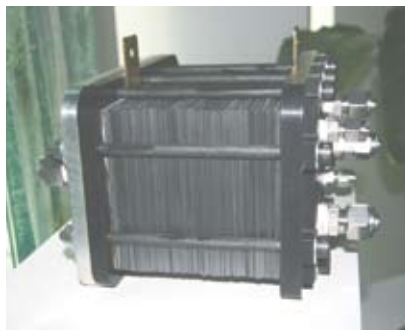
氫能發電機裡面有許多層薄膜，讓氫氣與氧氣結合，產生電能。
