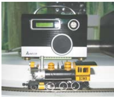
發電80W的氫能發電機與所驅動的模型火車。
